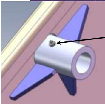
Le graissage de l'axe d'articulation s'effectue par le haut et à l'intérieur du bras
