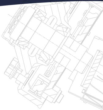
**FIGURE 1 C-2 MONTAGE ROULEMENT DANS LE MOYEU**
