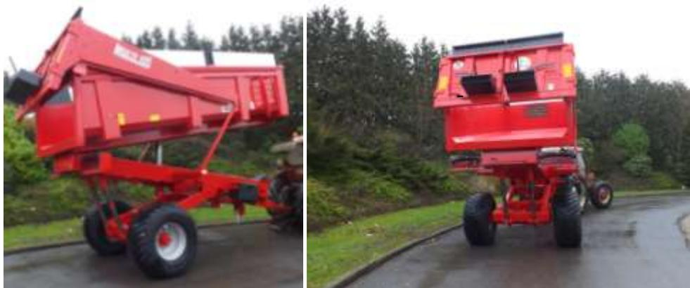
Pour l'utilisation de votre véhicule en version « SPECIAL VRAC », *il est impératif* de ne pas se pencher sous la bennes ou le châssis quand celle ci est levée ou en mouvement
