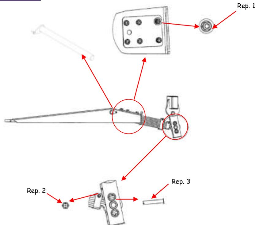
Veillez régulièrement resserrer toute les semaines et contrôler l'usure de la rondelle situé entre l'écrou et la plaque de flèche les 6 écrous Rep.1, les 2 écrous Rep.2, et s'assurer du bon état de la goupille de maintien de l'axe Rep.3.
