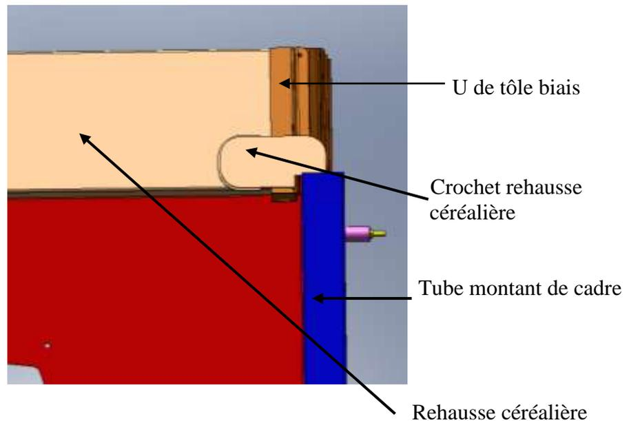
Pour monter la rehausse céréalière, glisser la rehausse dans le U soudé sur la tôle biais à l'arrière du véhicule, placer le crochet dans le tube du montant de cadre. **La rehausse céréalière ne doit être utilisée uniquement pour les céréales.** Laisser impérativement la rehausse céréalière pour assurer l'étanchéité de l'arrière du véhicule. Enlever la rehausse céréalière pour les betteraves, pomme de terre, terre, etc....)
