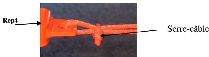
Assurez-vous de manière régulière que le câble de frein est tendu, vérifier le serrage des serre-câbles de tout le système de freinage. En cas de dégradation du câble de rupture rep1 ou du câble de frein rep6 procéder à la mise en place d'un nouveau câble (le câble de rupture est à changer tous les 3 mois tandis que le câble de frein est à changer tous les 2 ans).
