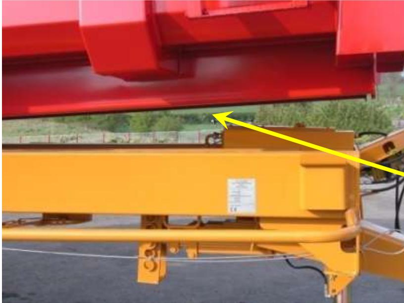
Lever la caisse d'un minimum 30 cm avant d'utiliser le système élévateur et cela pendant toute l'utilisation de celui
